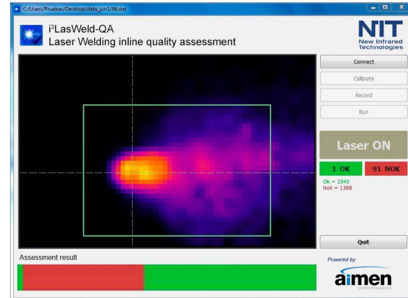
Imagen en tiempo real del melt-pool y detección de defectos
